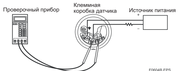
Рисунок 6.7 Подсоединение поверочного прибора
