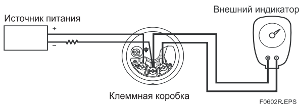
Рисунок 6.3 Подсоединение внешнего индикатора
